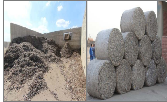
٥. منظومة إنتاج الـ RDF
